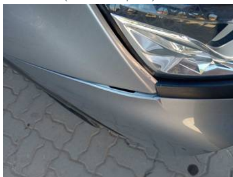
Bouclier avant (Défaut aspect)
